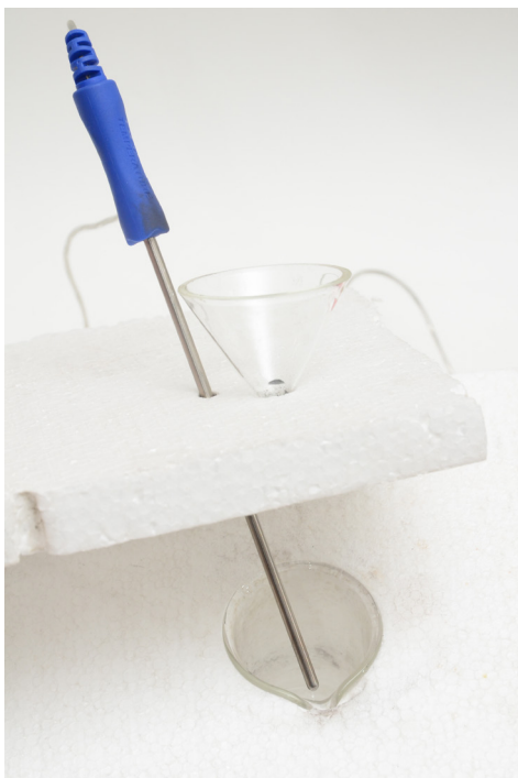
Obr. 4: Izolační část měřicí aparatury
