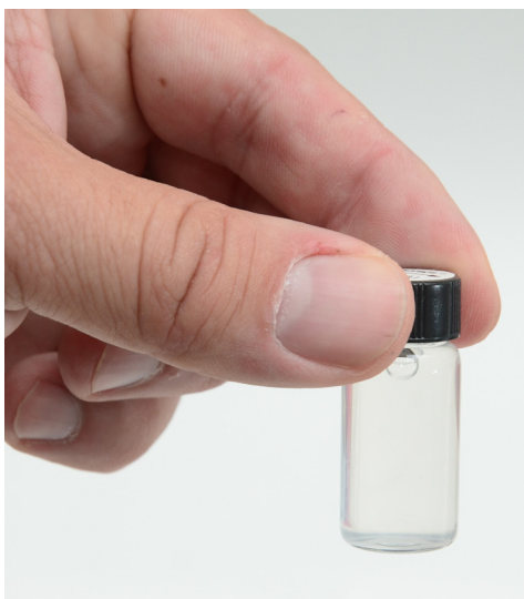
Obr. 5: Správné držení kyvety
