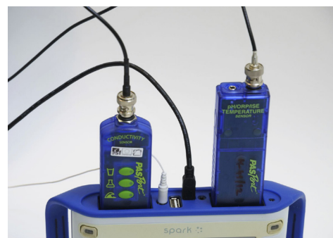
Obr. 3: Zapojení čidel na dataloggeru
