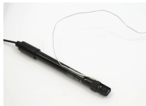
Obr. 2: Přilepení teploměru a nasazení míchadélka na konec čidla
