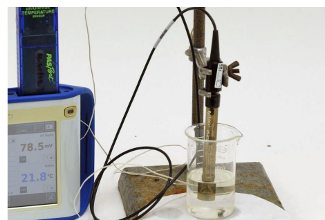
Obr. 3: ISE při měření kalibračního roztoku
