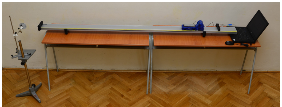
Obr. 2: Foto uspořádání experimentu Ověření 2. Newtonova zákona
