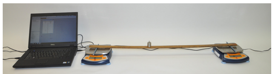
Obr. 2: Experimentální uspořádání pro rozklad sil na rovnoběžné složky
