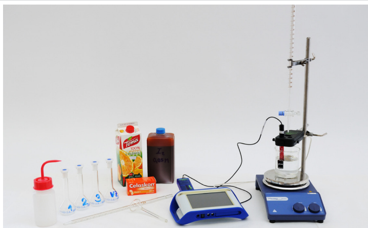
Obr. 3: Připravené pracovní místo s již připojenou ORP elektrodou
