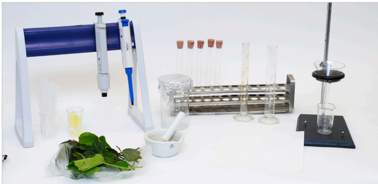
Obr. 4: Připravené pracovní místo pro homogenizaci, extrakci a filtraci
